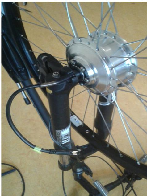
Wichtig ist, dass das Motorkabel nach dem Einbau nach unten hängt – mit einer Schleife, damit das Wasser abtropfen kann und nicht am Kabel in den Motor sickert.
