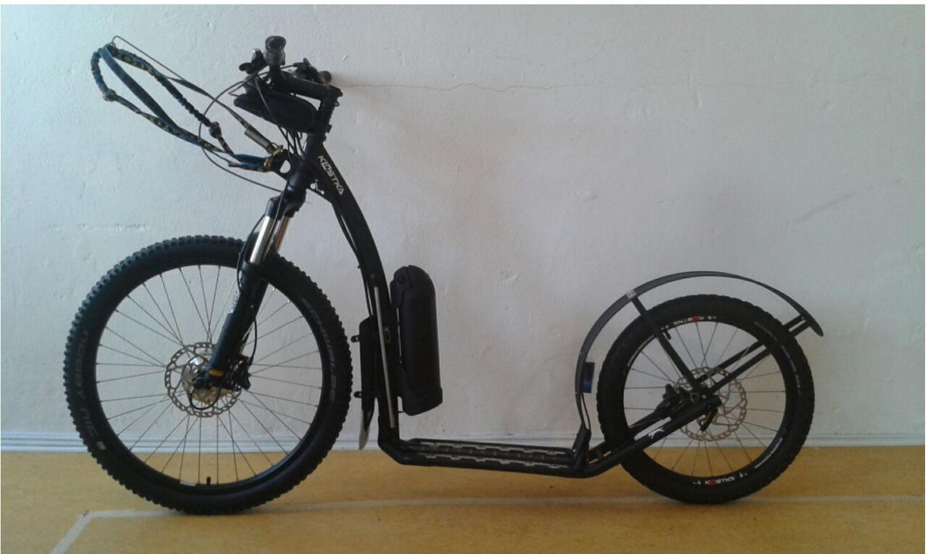
Der iTroll-Mushing ist speziell dafür eingerichtet, dass er einen Hund mit an der vorne überhängenden Leine mitnehmen kann. Das sogenannte Mushing.
