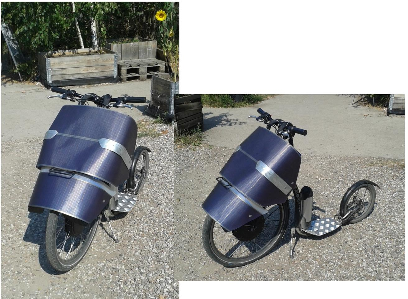
Der Vorbau wird dann komplett mit Solarfolie verkleidet. Die Verschaltung der Zellen sorgt dann dafür, dass immer der von der Sonne beschienene Teil aktiv zur Ladung der Akkus beiträgt. Auch hier steckt der Teufel im Detail, aber einfach mal ausprobieren, wie die Zellen reagieren.
