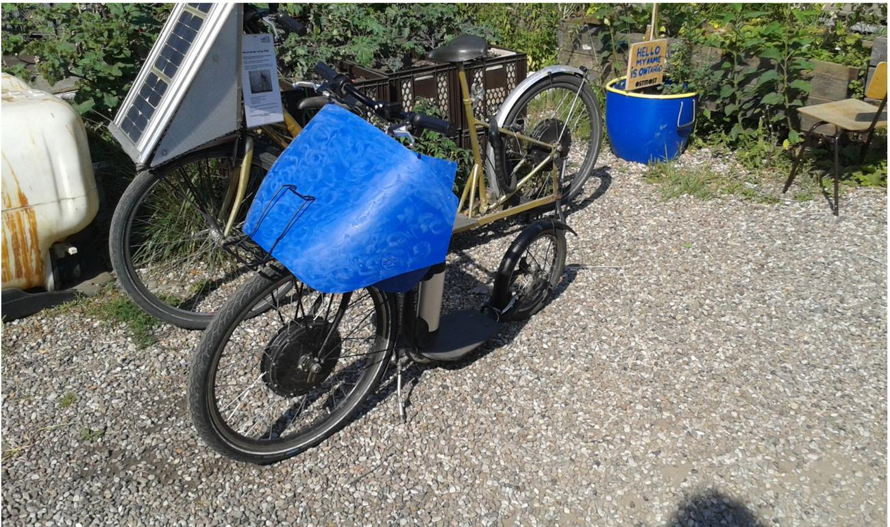
Wenn alles montiert ist und befestigt, kann die Solarfolie auf die Trägerkonstruktion aufgebracht werden. Die Folie wird mit doppelseitigem Klebeband aufgebracht und die Kanten zur Sicherheit nochmals mit Blindnieten und großen Unterlegscheiben befestigt.
